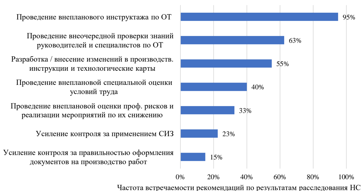
Рисунок 20 – Распределение частоты мероприятий, сформированных по результатам расследования несчастных случаев со смертельным исходом в 2023 году
